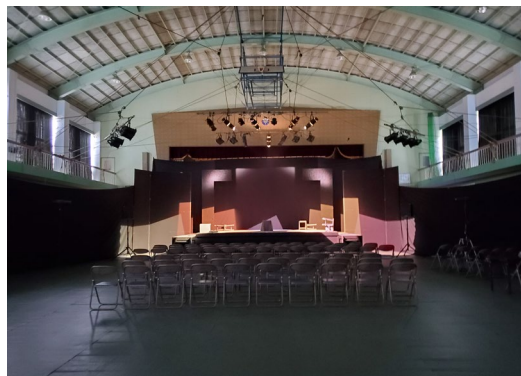
(写真②) 体育館の舞台を使用する場合。体育館の舞台に必要な広さは奥行約4m 間口約8m 体育館の条件や、観劇する人数によってこのように仕込みを行う場合もあります
